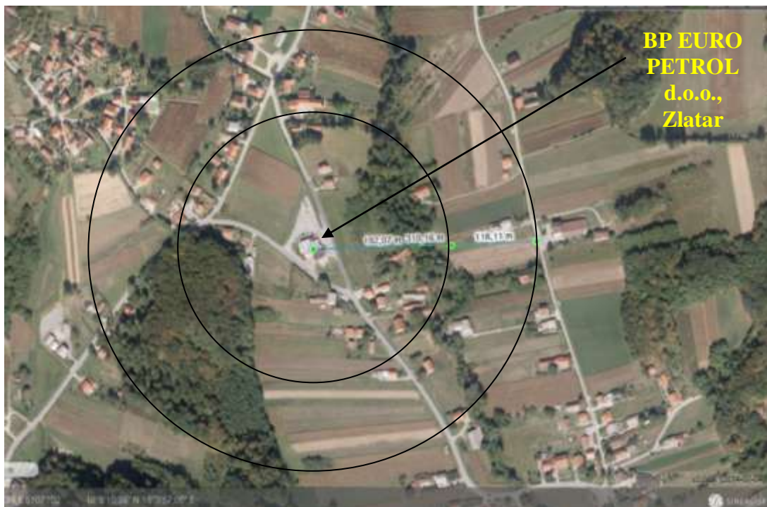
Slika 26. Radijus ugroženosti BP Euro Petrol d.o.o., Zlatar u slučaju eksplozije cisterne i punjenja spremnika Izvor podataka: arkođ preglednik
